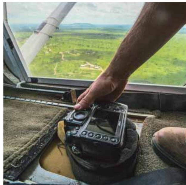
Mit einer in den Boden des Flugzeugs eingelassenen Kamera werden die Gnu-Herden fotografiert und später am Computer ausgezählt.
